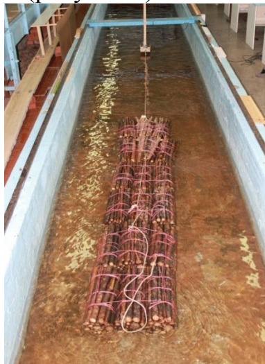
Рисунок 1 – Модель плота в лаборатории кафедры ИВР СибГТУ
