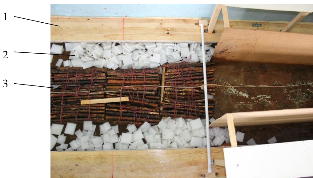
Рисунок 2 – Проведение опытов по определению сопротивления битого льда движению плота в лаборатории кафедры ИВР СибГТУ
