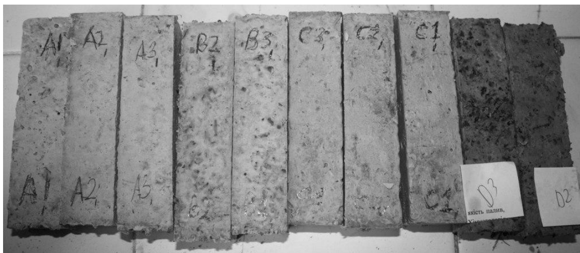
Рисунок 1 – Образцы строительных материалов на основе опавших листьев
