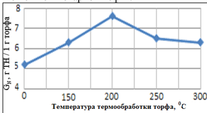
Рисунок 2 - Влияние термической обработки на нефтеемкость торфа (верховой торф R=5%, плотность нефти \rho_{20}=846,2 кг/м 3 )
