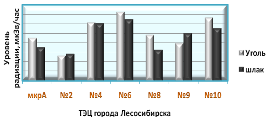
Рисунок 1 – Измерение радиационного фона угля и шлака
